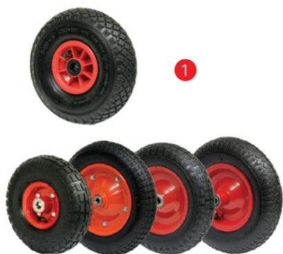
**Колесо:** Основание колеса выполнено из металла, либо полипропилена. Шина пневматическая. В колесах установлен качественный шариковый или роликовый подшипник. Колеса пневматические серии «28» обладают отличными амортизационными характеристиками и бережным отношением к поверхности пола. В каркасе шины имеется двухслойный либо четырехслойный корд.
